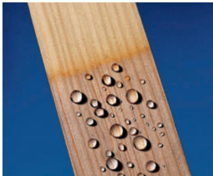
Die Wirkung einer Hydrophobierung nach sechs Monaten Bewitterung: links ohne, rechts mit wasserabweisender Imprägnierung.
